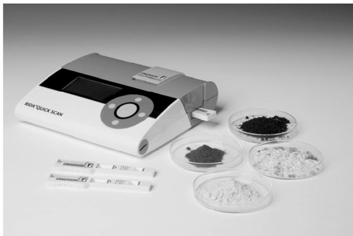
Anschließend wird anhand der gemessenen Bandenintensitäten der Gehalt an Mykotoxin in ppb oder ppm berechnet. Der RIDA®QUICK SCAN kann bis zu 100 Ergebnisse speichern. Diese können mit der mitgelieferten Software RIDA®QUICK SCAN Manage jederzeit per USB auf einen PC exportiert, gespeichert und bequem mit einem Datenverwaltungsprogramm wie beispielsweise Excel verwaltet werden.
